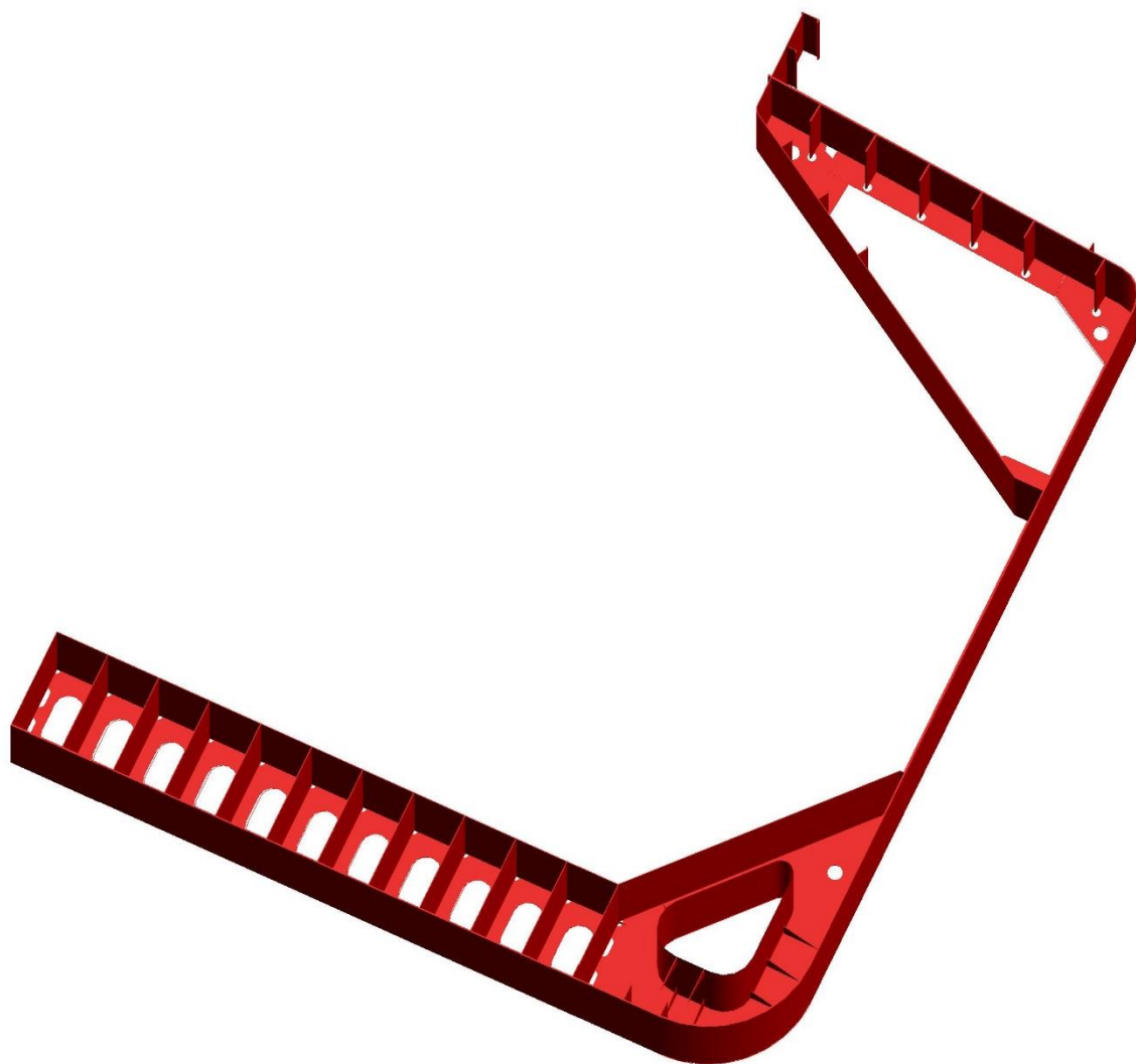
Рис. 9. Трехмерный мидель-шпангоут навалочного судна
