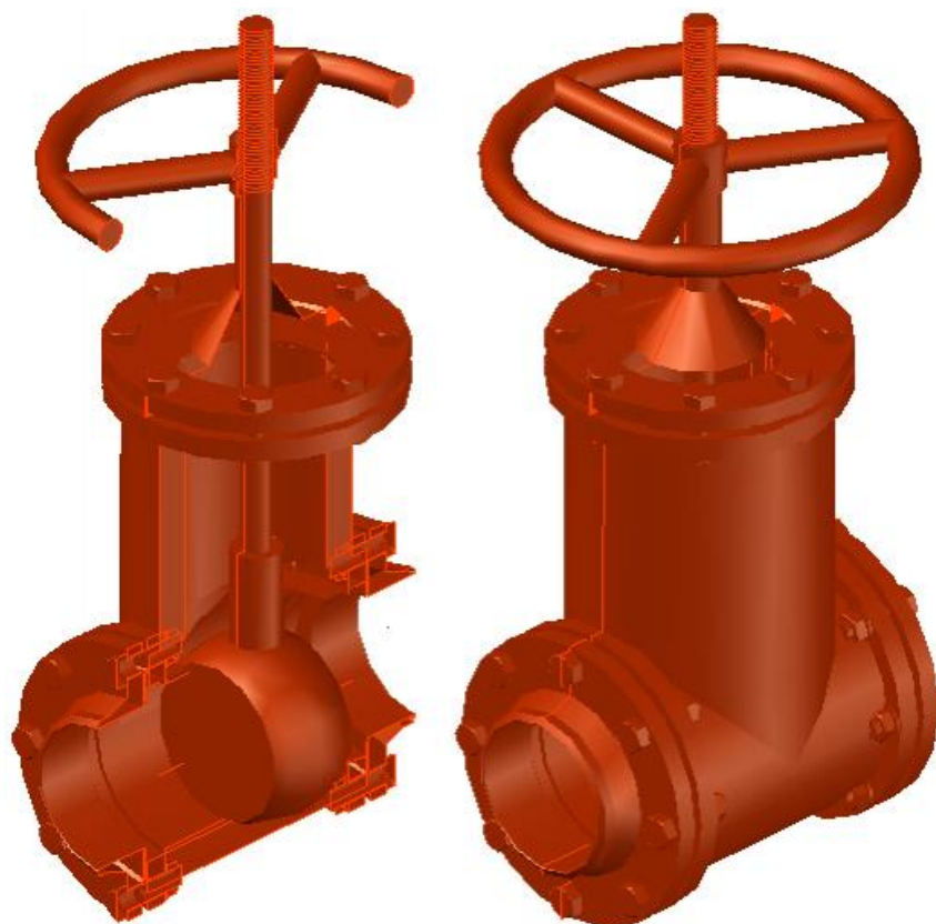
Рис. 14. Трехмерная модель клинковой задвижки
