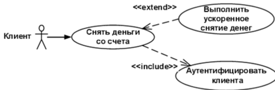
Рис.5. Пример связи включения и расширения
