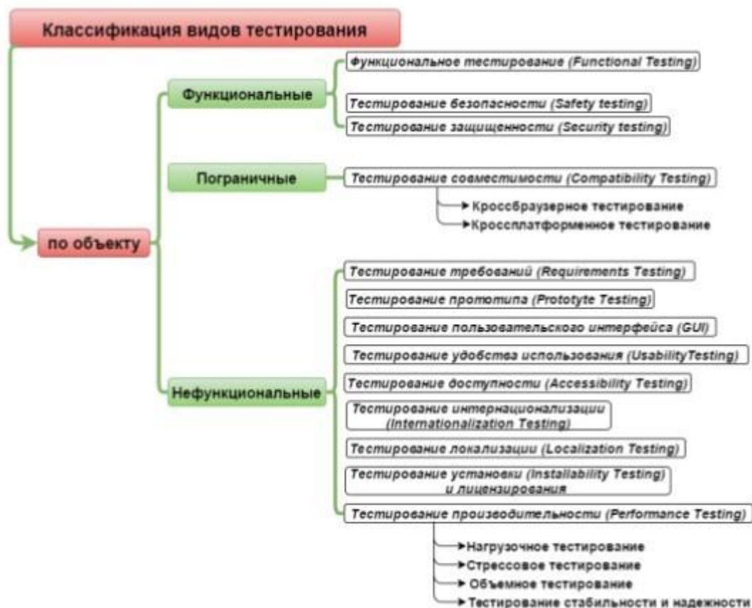
Рисунок 1 – Классификация видов тестирования в зависимости от объекта
