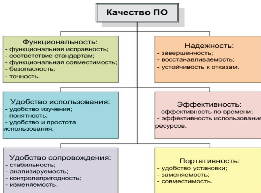
Модель качества программного обеспечения (ISO 9126)
