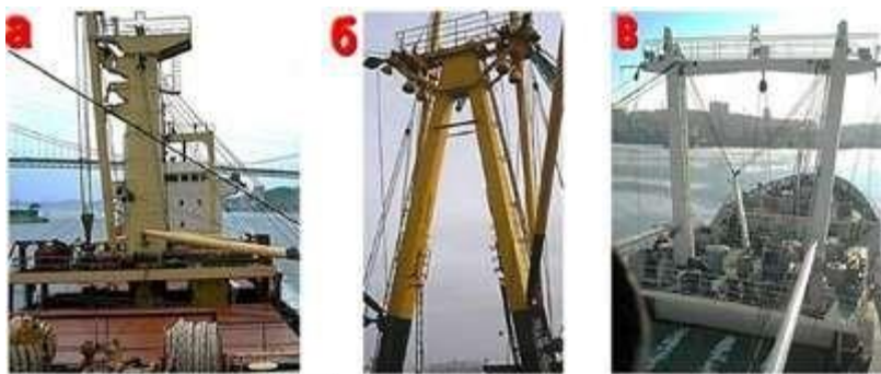
Рис. 6.63. Грузовые мачты: а – одиночная, б – Л-образная, в – П-образная
