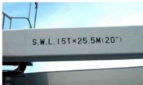
Рис. 6.73. Маркировка грузового крана Грузоподъемность 15 т при вылете стрелы 25,5 м и наклоне стрелы не менее 20°
