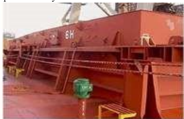
Рис. 6.74. Откидное люковое закрытие с гидроприводом: 1 — ведущая секция; 2 — ведомая секция; 3 — гнездо для стопорной планки; 4 — роульс ведомой секции; 5 — стойка-ограничитель; 6 — стойки; 7 — плунжер; 8 — резиновые амортизаторы; 9 — крайние крошечейны
