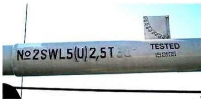
Рис. 6.72. Маркировка грузовой стрелы Грузоподъемность 5 т при наклоне стрелы к горизонту не менее 30° и 2,5 т при работе спаренными стрелами
