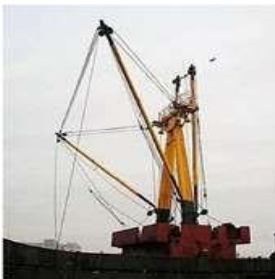
Рис. 6.64. Легкая грузовая стрела: 1 – манта; 2 – топенант; 3 – грузовой блок; 4 – грузовой шкентель; 5 – грузовой гак; 6 – оттяжка; 7 – стрела; 8 – канат на турачку грузовой лебедки; 9 – канат на барабан грузовой лебедки; 10 – лопарь топенанта; 11 – башмак; 12 – шпор стрелы; 13 – нок стрелы; 14 – бугель; 15 – топенант-блок
