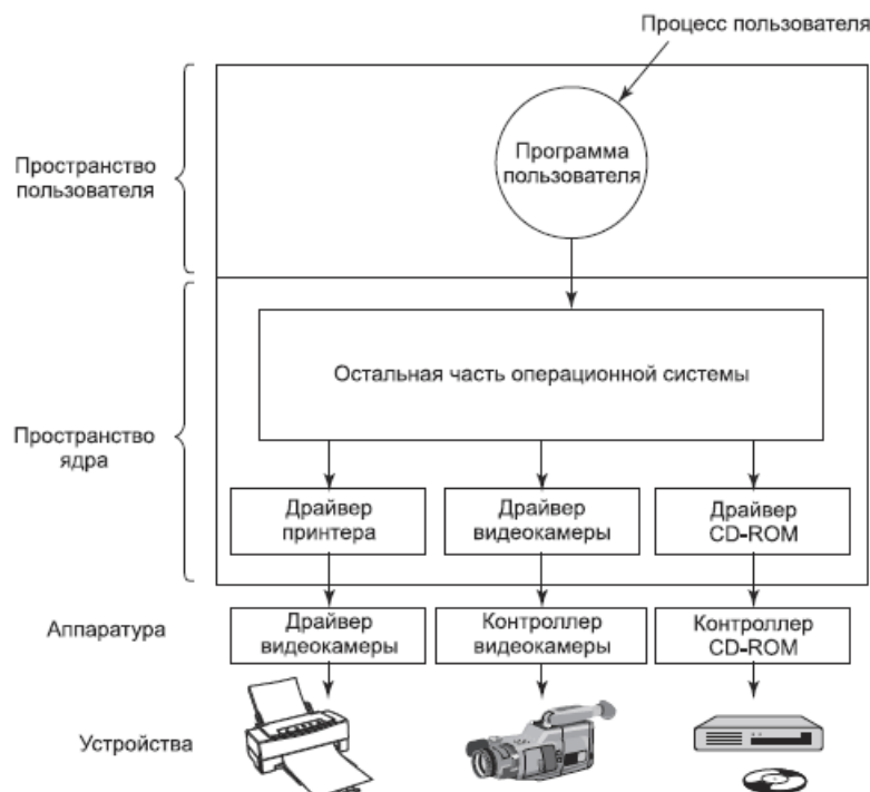
Рисунок 1 – Логическое позиционирование драйверов устройств
